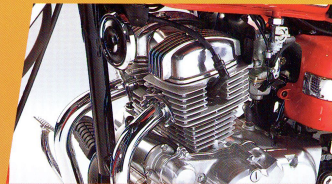
Antriebstechnik vom Feinsten: Zweizylinder-Viertakt-Reihenmotor
